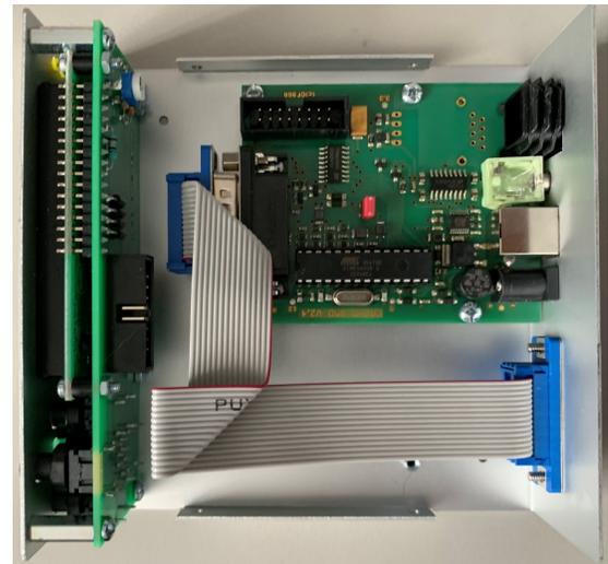
Stecken Sie das Flachbandkabel mit den 16-poligen Steckern in das ERC-M und die HID-Leiterplatte wie unten gezeigt.
