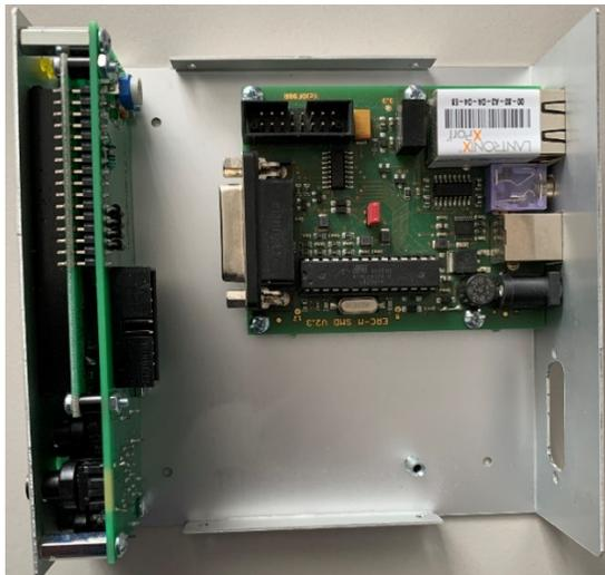
Falten Sie das Flachbandkabel mit den DSUB-Steckverbindern wie im Bild gezeigt. Stecken Sie den DSUB-Stecker auf die ERC-M-Platine und montieren Sie die DSUB-Buchse an die Gehäuserückseite. Verwenden Sie dazu 2 UNC4 5mm Bolzen.
